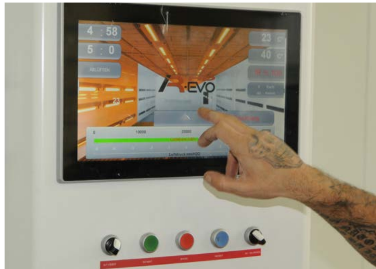
Mit einem intuitiv bedienbaren Touchscreen können einzelne Paneele ausgewählt werden, was die Effizienz der IR-evo weiter erhöht.
