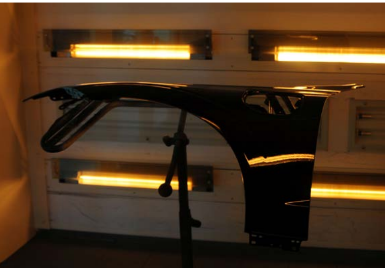
Die IR-evo HD von Bellini Systems trocknet ausschliesslich mit Infrarot.
